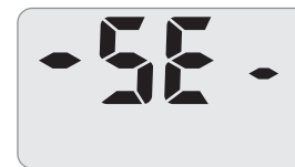
スプール回転不良
