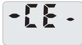
コントロールボックスエラー
