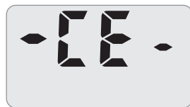
コントロールボックスエラー
