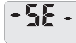
スプール回転不良
